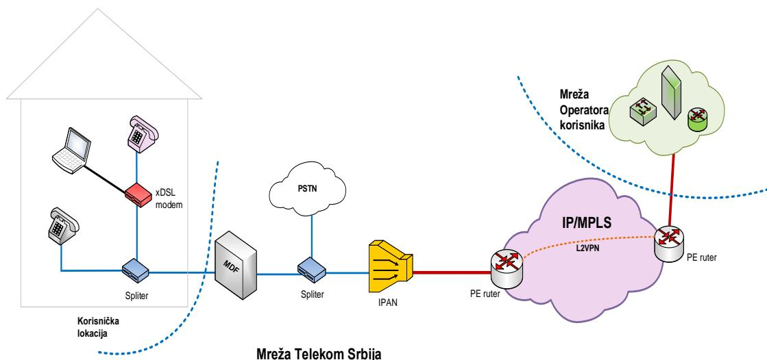
Na prvom segmentu, xDSL modem – IPAN, definiše se jedinstveni V-PVC 8/36 za voice za pristup preko ADSL tehnologije, odnosno VLAN ID 100 za voice ATA i 101 za voice (bridged mode) za pristup preko VDSL tehnologije. Operator korisnik konfiguriše V-PVC odnosno user VLAN na xDSL modemu, a Telekom Srbija konfiguriše IPAN. Na strani IPAN konfiguriše se odgovarajući dot1p (cos) bit kao i profil za ograničenje brzine.
